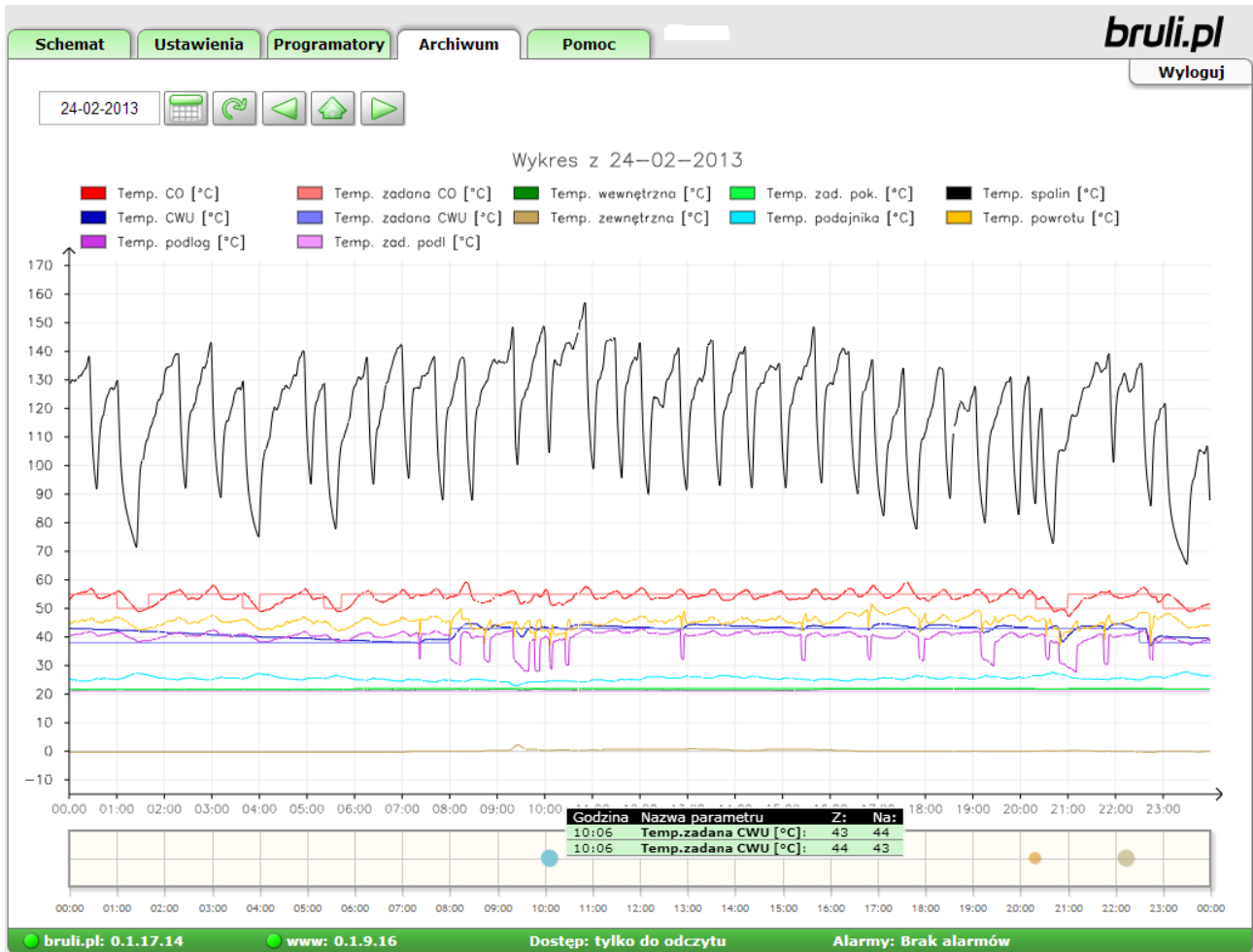
Ilustracja 21: Wykresy z zarejestrowanymi parametrami pracy kotła
