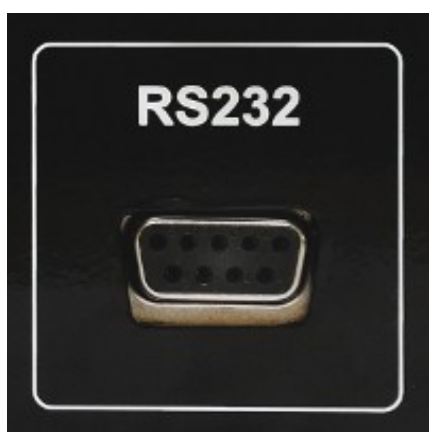
Ilustracja 11: Złącze RS232 w sterowniku
